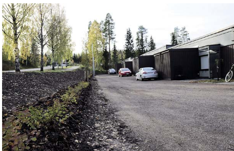
Tuulimyllyntien ja piha-alueen ja välistä poistettiin terijoensalavat, koska niiden juurilla on taipumus tunkeutua salaojaputkiin.
